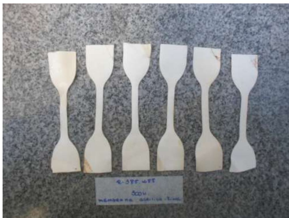
Foto 2. Amostras após 300 horas de exposição ao intemperismo.
